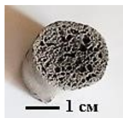
Рис. 5. Внешний вид и микроструктура образца термопеносиликата с добавкой смеси мела и буры
